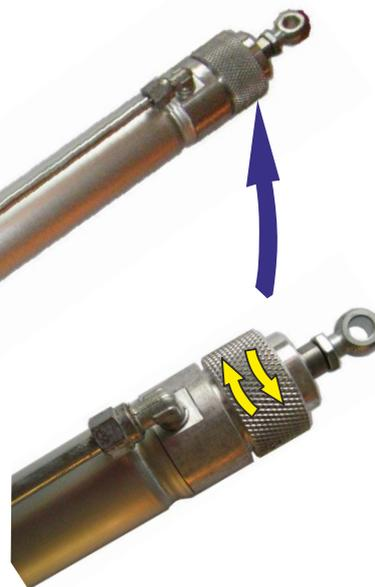
Pour **RENTRE**R la tige manuellement, tourner la molette vers la droite ou la gauche et **POUSSER** simultanément sur la tige.
