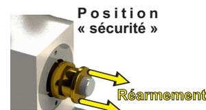
Visser manuellement la nouvelle cartouche pleine jusqu'en butée. Vérifier le bon état de la cartouche de réserve. Remettre en place le cache à éjecter. Fermer la porte et mettre un nouveau scellé.
