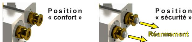
Visser manuellement la nouvelle cartouche pleine jusqu'en butée. Vérifier le bon état de la cartouche de réserve. Remettre en place le cache à éjecter. Fermer la porte et mettre un nouveau scellé.
