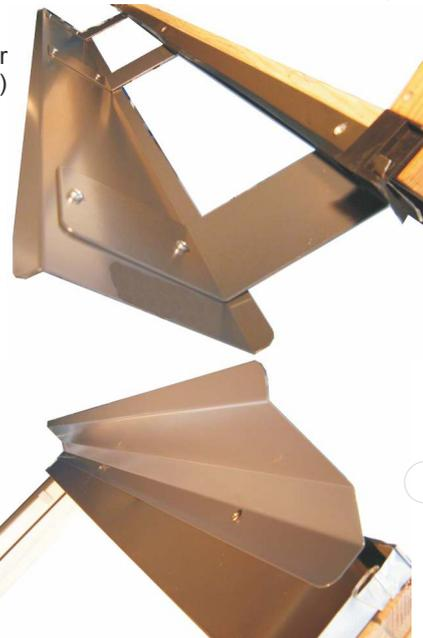
Enlever les vis du profil supérieur FAKRO® du dormant en partie haute. Mettre en place et fixer le déflecteur sur le profil supérieur FAKRO®. (vis TF VBA Ø4 x 45)
