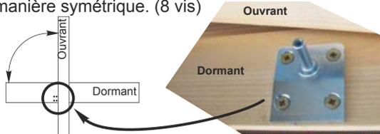
En utilisant les trous pré-perçés, fixer sur chaque coté de l'ouvrant, les supports rotule de manière symétrique. (4 vis)
